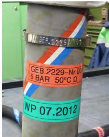
Abbildung 18: Beispiel einer gekennzeichneten Schlauchleitung
